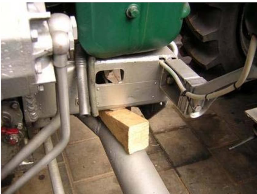
Man schlägt links und rechts Keile zwischen Vorderachse und Vorderachsbock damit beim Auseinanderfahren sich der Traktor nicht zur Seite neigt. Ferner geben wir auch etwas unter den Mähantrieb - dieses ist reine Gefühlssache, aber es darf nicht zu sein. Der Traktor sollte sich in der Waage halten.
