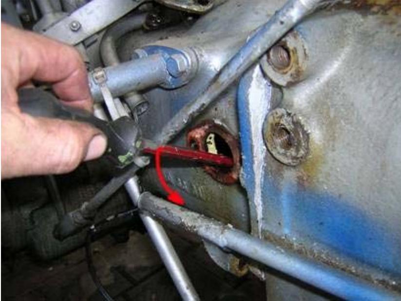
Da wir jetzt den Moment erreicht haben, wo sich das Differential nicht mehr weiter bewegt und der Grund hierfür an der Zapfwelle liegt, beheben wir dieses indem wir mit einem Schraubenzieher die Zapfwelle nach oben drücken müssen. Dies geschieht dadurch, dass man den Schraubenzieher an der Welle angesetzt nach unten drücken. Es gibt einen kleinen Ruck und schon können wir weiter zusammenschrauben.
