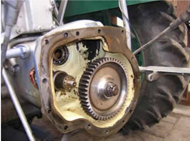
Jetzt montieren wir das neue Zahnrad. Sollte dies schwer gehen, empfiehlt es sich, die Mitte mit einem Gasbrenner auf ca. 100 Grad zu erwärmen - dann lässt es sich leicht raufschieben. Sitzt es - Beilage drauf, Mutter wieder fest angezogen und Sicherungssplint reingegeben. Man muss darauf achten, dass dieses Zahnrad richtig montiert wird. Man kann dieses auch verkehrt raufschieben.
