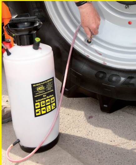
1. Ventil ausschrauben Füllschlauch aufstecken
