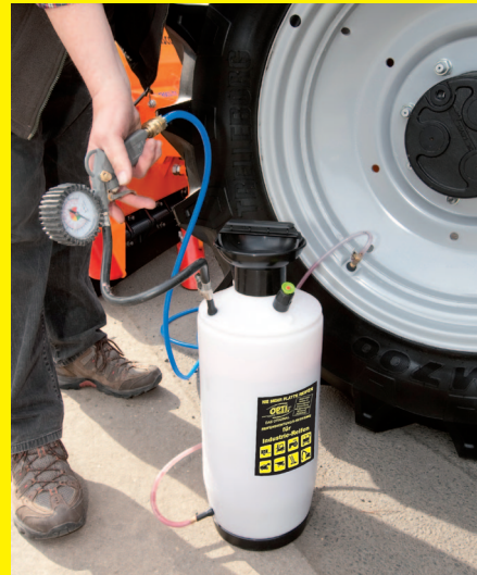
2. Füllmenge laut Tabelle mit 2,0 bar Druck in den Reifen füllen
