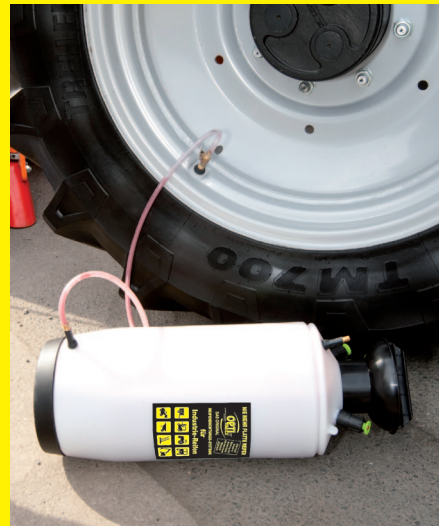
4. Nach Befüllung „DFB“ flach legen. Druckluft kann über Füllschlauch entweichen und reinigt diesen sogleich. Ventil wieder einsetzen. Reifen aufpumpen und losfahren.
