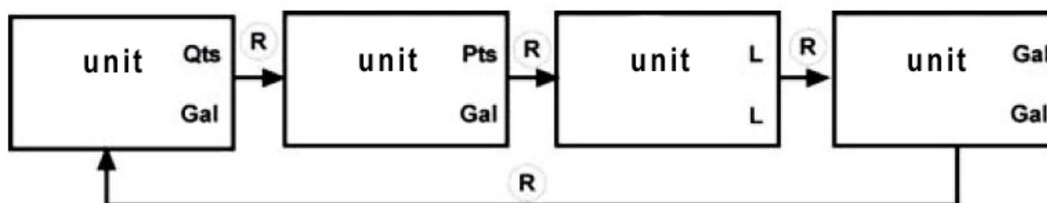
**4** = Durch abschließendes langes Drücken des CAL Knopfes wird die gewünschte, neue Einheit gespeichert.
