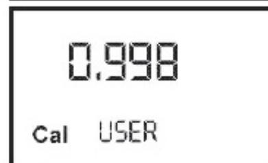
Das unten eingefügte Flussdiagramm zeigt die zusammenhängende Logik der verschiedenen Anzeigen auf. In diesem Zustand kann mit dem RESET Knopf vom „user“ zum „fact“ Faktor gewechselt werden. Zur Bestätigung der Kalibrierfaktor Wahl müssen Sie kurz den CAL Knopf drücken, während „user“ oder „fact“ angezeigt wird. Nach dem Neustart verwendet der Literzähler den soeben bestätigten Kalibrierfaktor.
