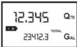
Wird das Zählwerk weiterhin ohne Austausch der Batterien verwendet, tritt die zweite Stufe ein & der Betrieb des Zählwerks ist nun gar nicht mehr möglich. In diesem Zustand blinkt das Batteriesymbol nur noch & es ist nichts anderes auf dem LCD-Display mehr sichtbar.
