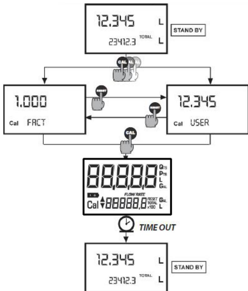
**Hinweis:** In dem Moment, in dem der Faktor des Herstellers bestätigt wird, wird der alte Faktor des Benutzers aus dem Speicher gelöscht.
