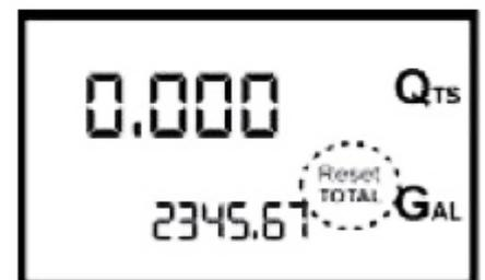
Das LCD-Display zeigt erneut alle seine Segmente, danach folgt die Phase, in der alle Segmente ausgeschaltet sind um schließlich zur Anzeige überzugehen, auf der die genullte Gesamtmenge „Reset Total“ angegeben wird.
