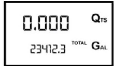
nach wenigen Sekunden wird „Reset Total“ durch die NICHT nullbare Gesamtmenge & den Schriftzug „Total“ ersetzt.
