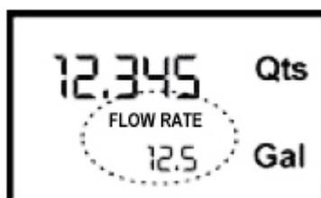
Der Schriftzug „GAL“ neben der Flow Rate bezieht sich auf das Register der (nullbaren oder nicht nullbaren) Gesamtmengen, die erneut angezeigt werden, wenn der Anzeigemodus der Durchflussmenge wieder verlassen wird.
