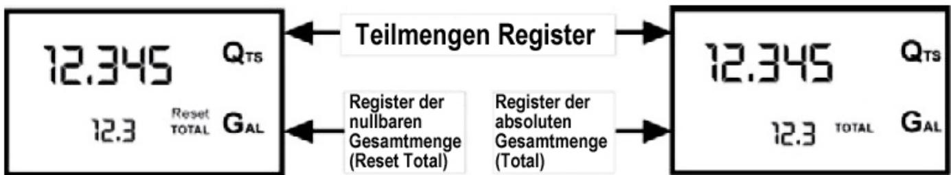
**Hinweis:** Für die Gesamtmengen stehen 6 Ziffern zur Verfügung zzgl. x10/x100. Die Erhöhung erfolgt mit folgender Sequenz: 00.0 -> 99999.9 -> 999999 -> 100000 x 10 -> 999999 x 10 -> 100000 x 100 -> 999999 x 100
