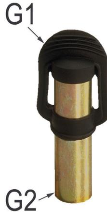
1. Montieren Sie den Steck-Aufsatz für die Rundleuchten an der Karosserie des Fahrzeugs senkrecht zur Straße. Sie können diese entweder anschrauben oder anschweißen.
