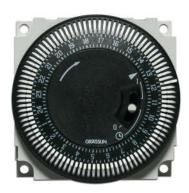
Der weiße Pfeil muss auf die aktuelle Ist-Zeit (Tageszeit) eingestellt werden. Auf der Zeitschaltuhr ist ein Kreis mit kleinen blauen Schaltern um die Ziffernanzeige angebracht. Möchten Sie, dass die Uhr zu einem bestimmten Zeitpunkt aktiv wird, drücken Sie die blauen Schalter für diesen gewünschten Zeitraum hinunter. Ein blauer Schalter steht für 15 min.
