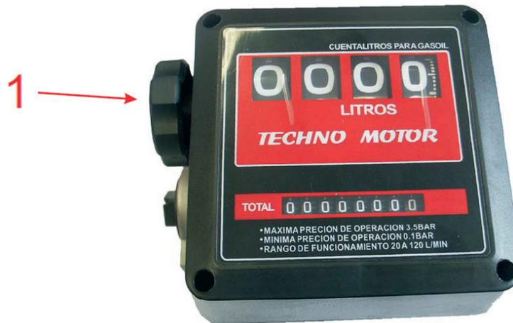
Der Literzähler 03857 ist ein mechanischer Literzähler mit Schwingscheibe, für die Messung von Dieselöl oder leichtem Heizöl. Die Schwingscheibe der Messkammer, die von der Flüssigkeit bewegt wird, betätigt das Zahnradgetriebe, das sich im Deckel des Literzählers befindet und den Literzähler bewegt. Der Zähler ist mit einer nicht zurücksetzbaren Zählwerkanzeige in Litern sowie mit einer Teilmengenanzeige ausgestattet, die mit Hilfe des Knopfes "Pos 1" zurückgesetzt werden kann.
