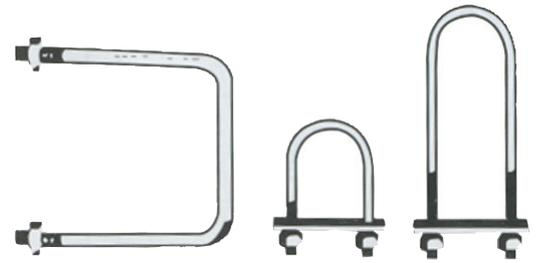
Bevor Sie eine Reihe von U-Bolzen machen, sollte zunächst eine Testbiegung mit Material ohne Gewinde vorgenommen werden. Überprüfen Sie Dimensionen und nehmen Sie notwendigen Anpassungen vor. Achten Sie darauf, den Sperrblock so nah wie möglich am Mittelstift oder dem Umformwerkzeug zu positionieren, um das Material am Verrutschen zu hindern.
