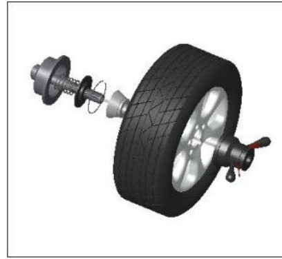
Hauptwelle-passender Kegel (großer Kopf nach innen) -- Rad -- Schnellgriffmutter
