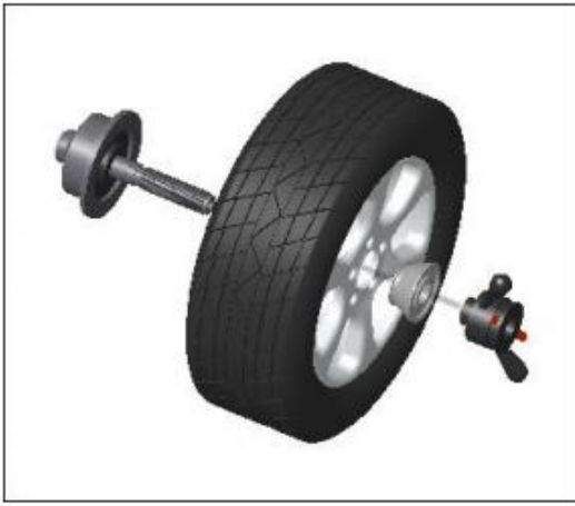
Hauptwelle-Rad -- passender Kegel (kleiner Kopf nach innen) -- Schnellgriffmutter
