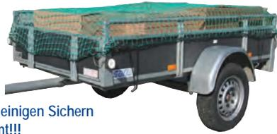
!!!Nur zum Abdecken, nicht zum alleinigen Sichern von Lasten an Fahrzeugen bestimmt!!!
