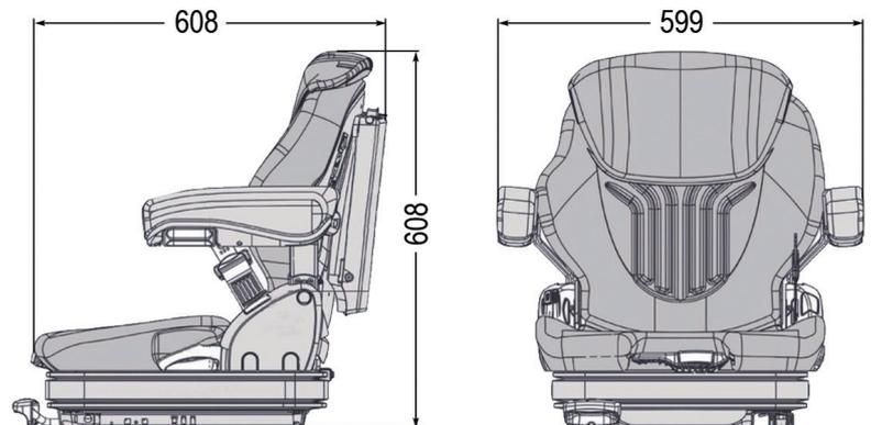
Die mit 12 V oder 24 V betriebene niedrigaufbauende Niederfrequenzfederung sorgt für guten Fahrkomfort. Das Fahrgewicht lässt sich mit der pneumatische Federung per Knopfdruck von 45 bis 170 kg einstellen. Das Oberteil, Rückhaltesystem sowie Lordosenstütze lässt sich auf Ihre Bedürfnisse einstellen.
